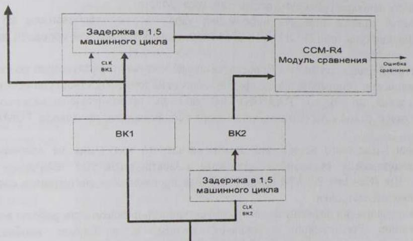
Рисунок 2 – Обеспечение безопасности в контроллерах TMS
