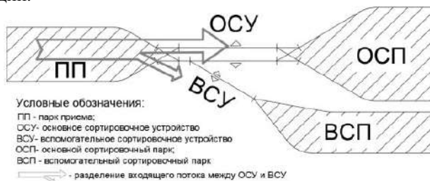
Рисунок 2 – Разделение входящего потока между сортировочными устройствами
