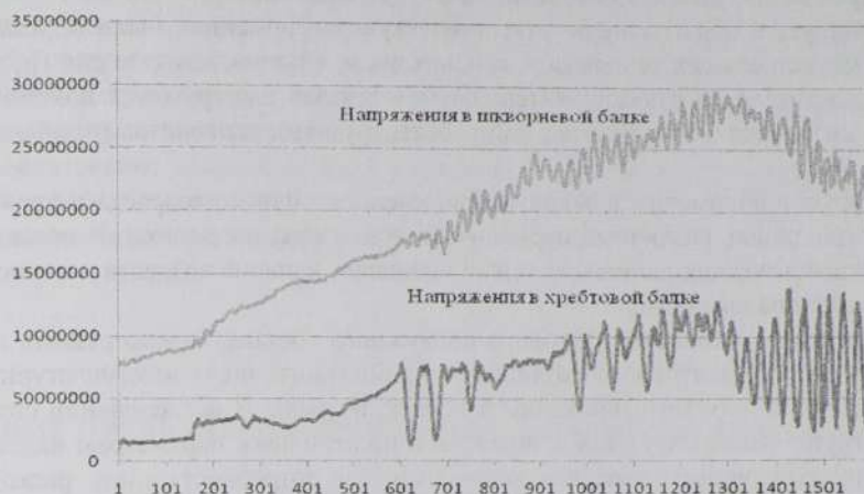
Рисунок 3 – Напряжения в шкворневой и хребтовой балках (Па) за время удара
