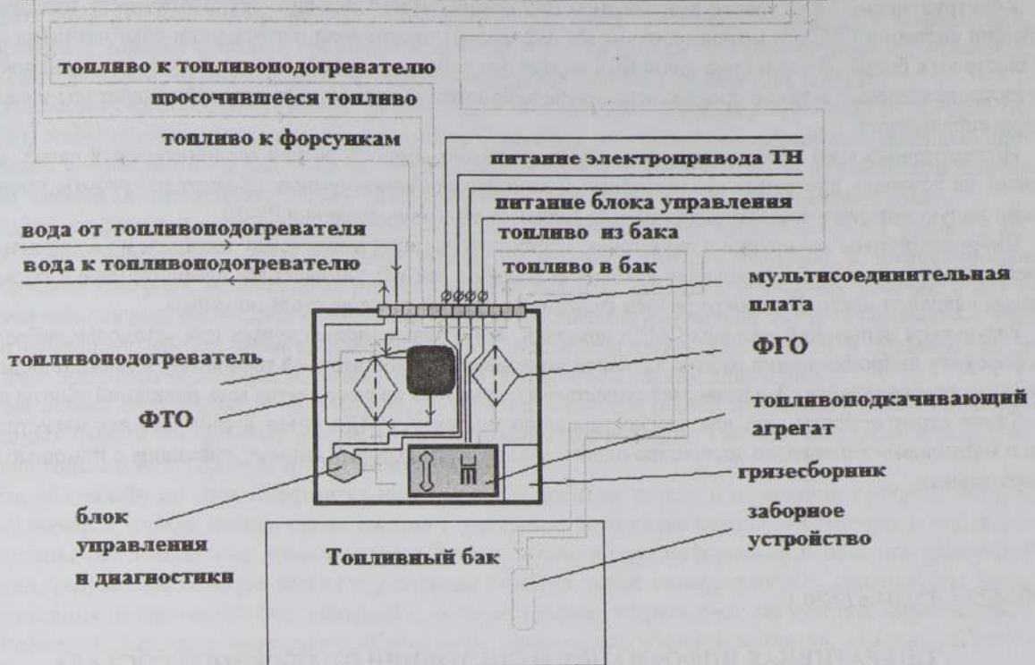
Рисунок 1 – Вариант модуля топливной системы
