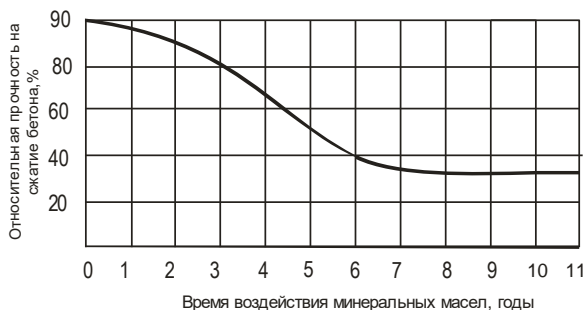
Рисунок 5.17 – Зависимость прочности бетона на сжатие от времени воздействия минеральных масел
