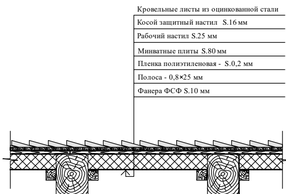
Рисунок 9.8 – Состав покрытия (проектный)
