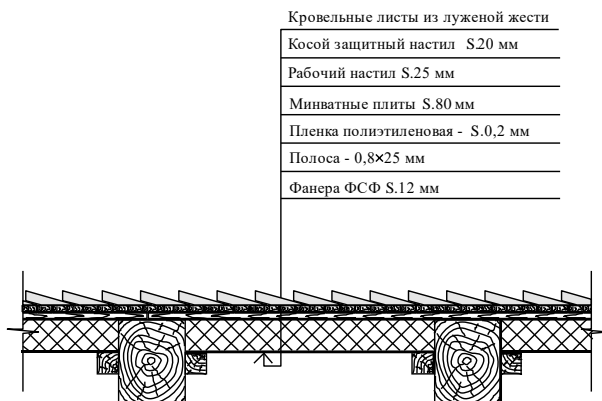
Рисунок 9.7 – Состав покрытия
