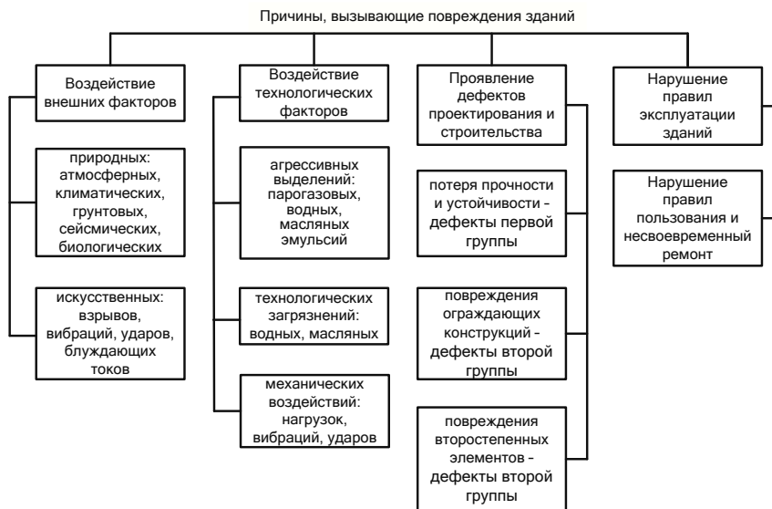
Рисунок 4.1 – Классификация причин повреждений зданий в процессе эксплуатации
