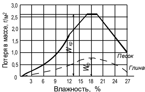
Рисунок 5.9 – Интенсивность коррозии в различных грунтах в зависимости от влажности (а) и концентрации солей в электролите (б)
