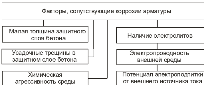
Рисунок 5.16 – Классификация факторов, сопутствующих коррозии арматуры
