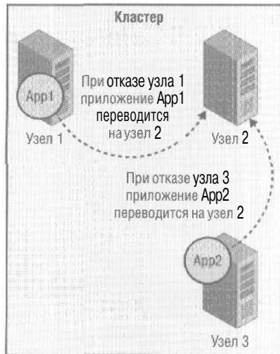
Рис. 13-8. Кластер, использующий миграцию на сервер для «горячей» замены
