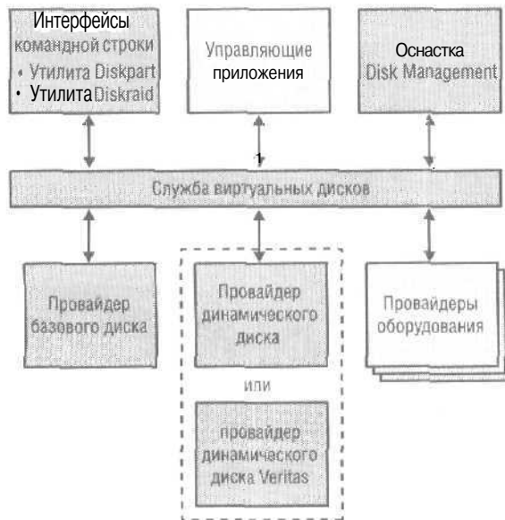
Рис. 11-1. Архитектура службы виртуальных дисков
