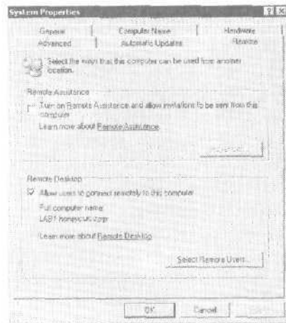
Рис. 7-3. Удаленный рабочий стол устанавливается по умолчанию и легко включается на вкладке Remote панели System Properties
