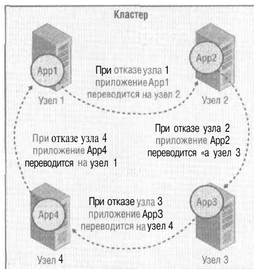
Рис. 13-10. Схема кластера с миграцией по кругу
