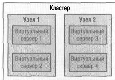
Рис. 13-3. Схема физической организации виртуальных серверов на кластерном сервере
