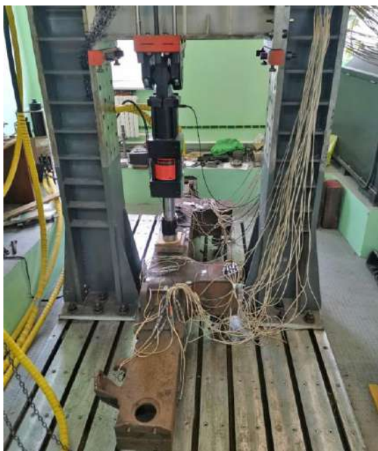
Рисунок 1 – Проведение натуральных испытаний рамы тележки
