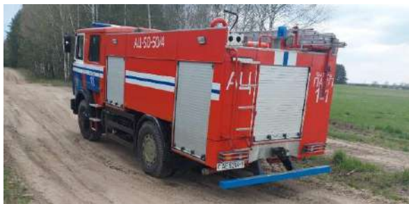
Рисунок 2 – Движение пожарной автоцистерны на шасси МАЗ-5337 с резервуаром объемом 5 м 3 в соответствии с режимом № 2
