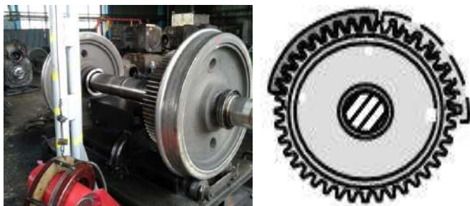
Рисунок 4 – Нанесение магнитной суспензии при проведении МПК зубчатых колёс дефектоскопом УМДЗ
