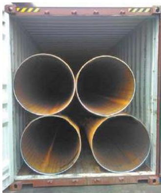
Рисунок 5 – Размещение труб в универсальном контейнере
