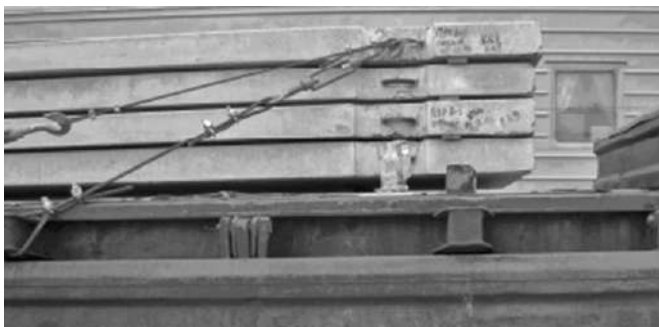
Рисунок 2 – Многоярусная погрузка железобетонных плит
