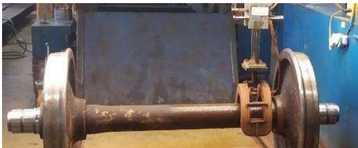
Рисунок 5 – Нанесение МИ при проведении МПК средней части оси КП дефектоскопом МД-12ПС
