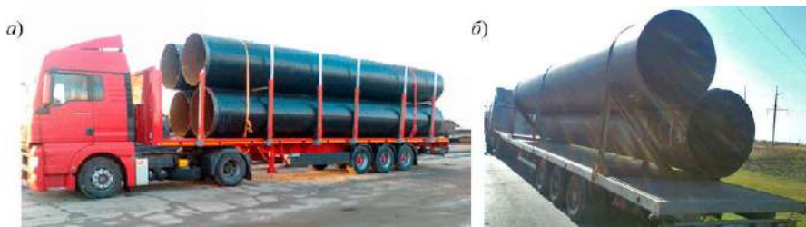
Рисунок 4 – Размещение и крепление труб на полу автотранспортного средства (а) и с помощью турникетного устройства (б)
