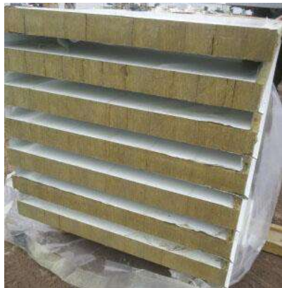
Рисунок 1 – Транспортный пакет сэндвич-панелей
