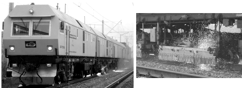
Рисунок 21 – Рельсошлифовальный поезд РШП-48
