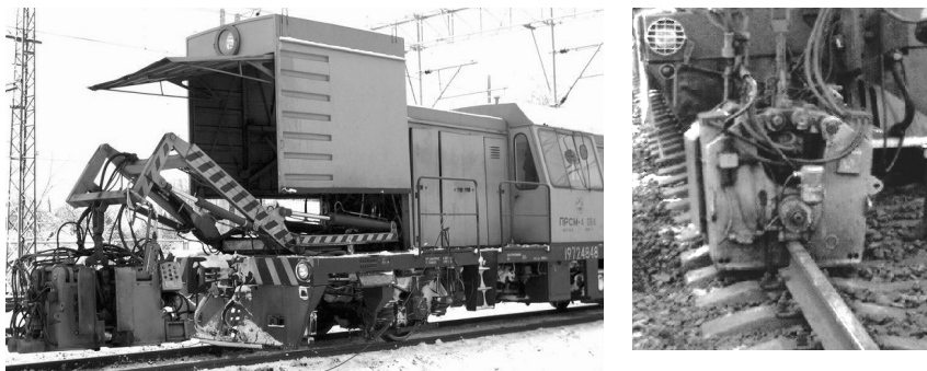
Рисунок 20 – Машина для сварки рельсов в пути ПРСМ-4
