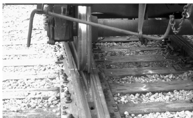
Рисунок 13 – Колесная пара при прохождении крестовины
