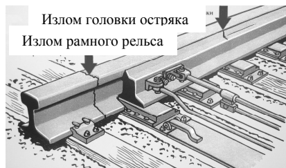
Рисунок 18 – Излом остряка, рамного рельса
