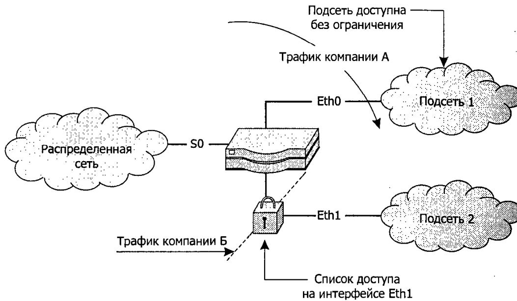
Рис. 9.2. Настройка списков доступа для подсети 2
