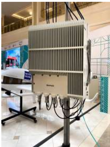
Рисунок 1 – Базовая станция 5G
