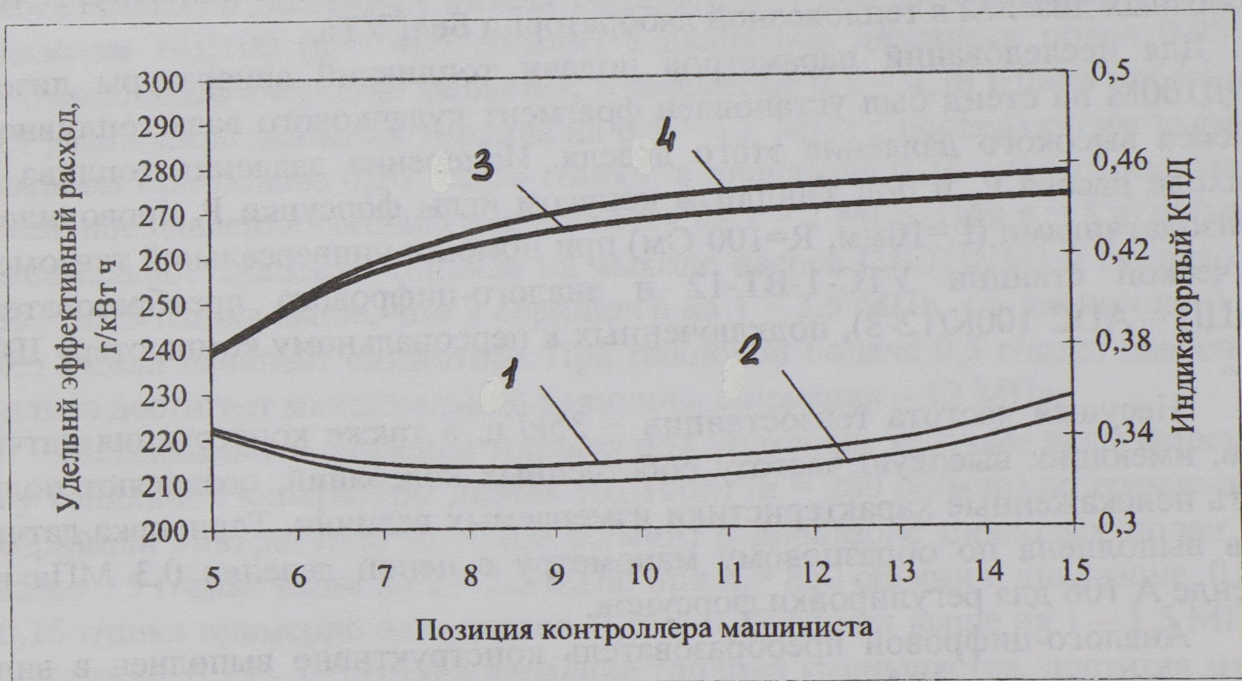
Рис. 2. Изменение удельного эффективного расхода топлива и индикаторного КПД дизеля 10Д100М от позиции контроллера машиниста по тепловозной характеристике: 1,2 — удельный эффективный расход топлива; 3,4 — индикаторный КПД; 1,3 — P_3 = 21 МПа; 2,4 — P_3 = 28 МПа.
