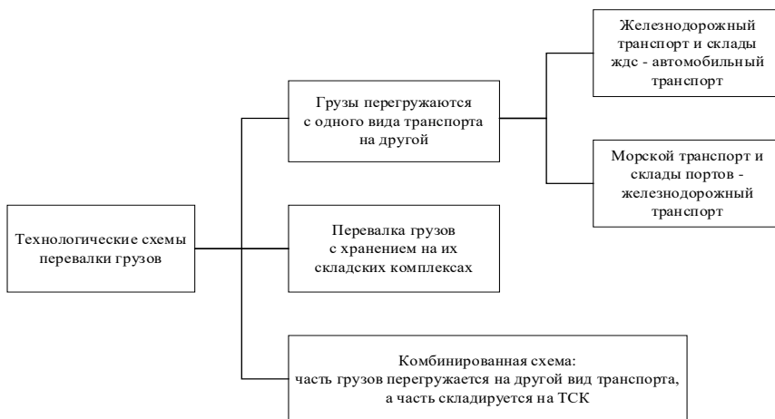
Рисунок 1 – Технологические схемы перевалки грузов
