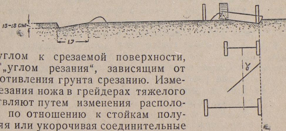
Рис. 13. Первый проход — пробивка.
