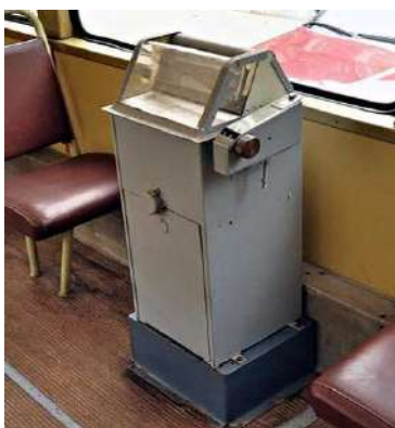
Рисунок 1 – Кассовый аппарат по оплате проезда в салоне трамвая
