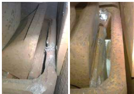
Рисунок 2 – Последствия поперечного излома подвижных пластин
