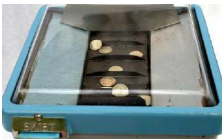
Рисунок 2 – Конструкционные особенности кассового аппарата общественного транспорта
