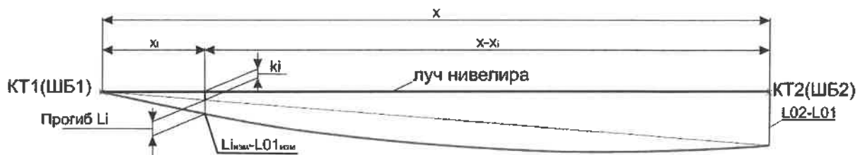
Рисунок 5 – Методика установления прогиба балок машины
