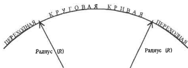
Рисунок 2 – Схема закругления с переходными кривыми
