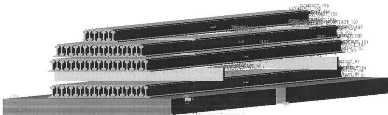
Рисунок 4 – Компьютерная модель крепления рельсов на сцепе из двух платформ в MSC ADAMS
