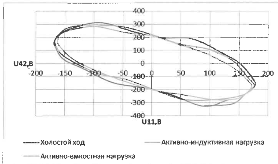
Рисунок 4 – Фигуры Лиссажу при различных видах нагрузки
