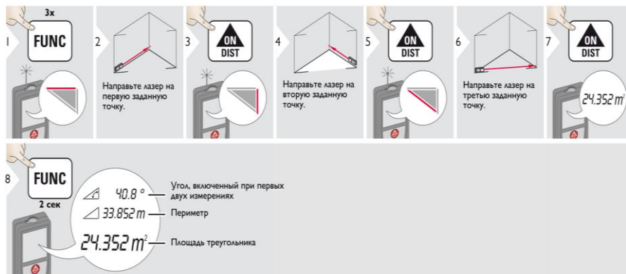
Рисунок 4.12 – Определение площадей треугольника лазерным дальномером Leica Disto TM X310
