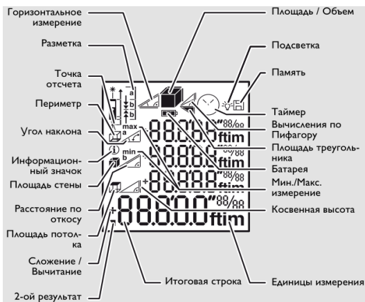
Рисунок 4.3 – Устройство дисплея лазерного дальномера Leica DistoTM X310.
