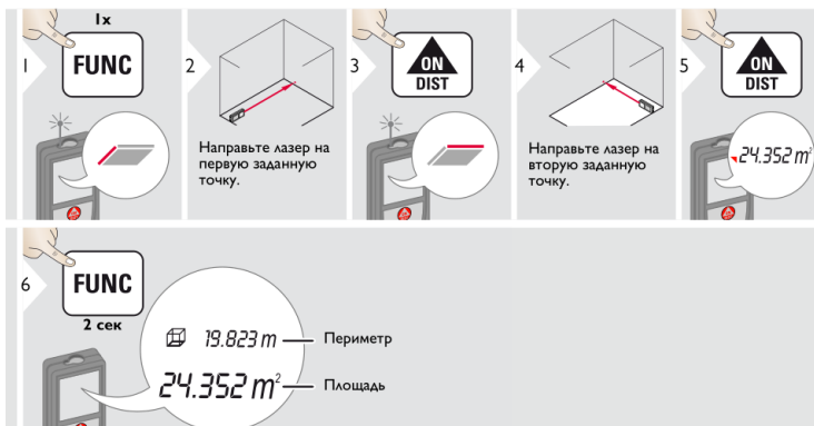
Рисунок 4.10 – Определение площадей лазерным дальномером Leica Disto TM X310
