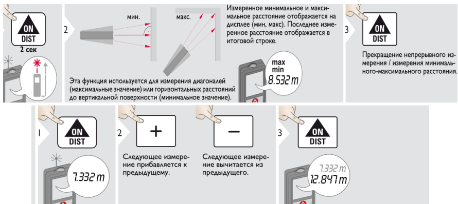
Рисунок 4.9 – Непрерывные измерения лазерным дальномером Leica Disto TM X310
