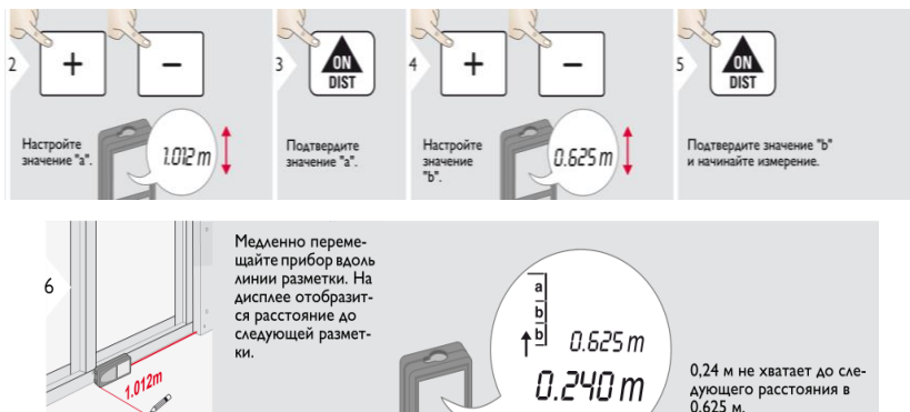
Рисунок 4.14 (окончание) – Вынос проектных расстояний лазерным дальномером Leica Disto TM X310
