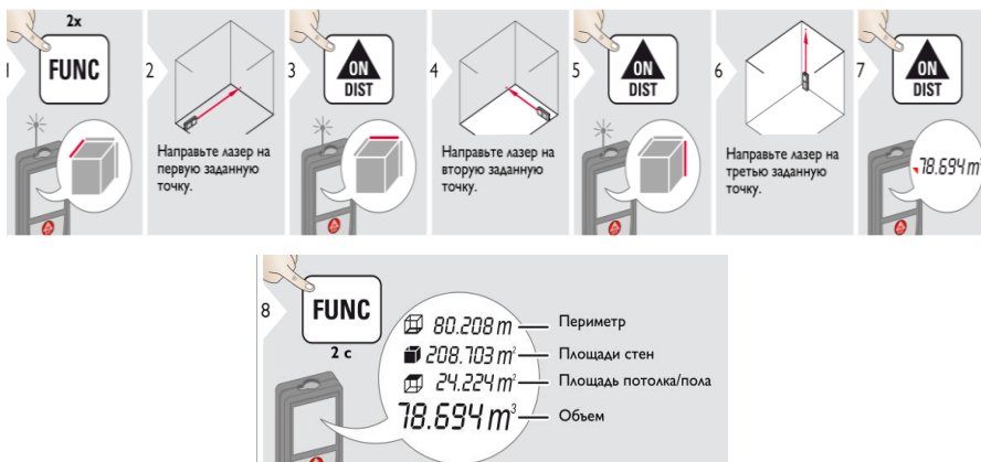
Рисунок 4.11 – Определение объемов лазерным дальномером Leica Disto TM X310
