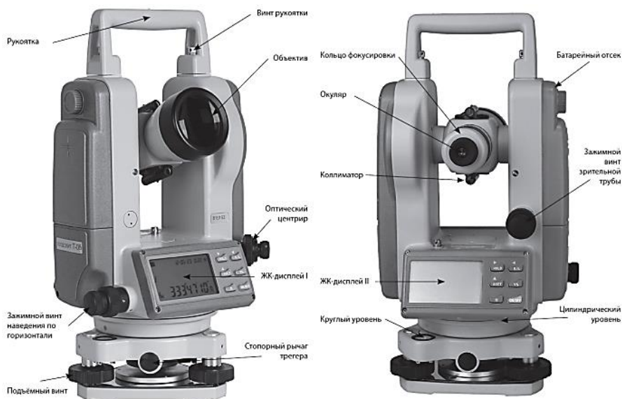
Рисунок 11.1 – Электронный теодолит ET-02 и его основные компоненты
