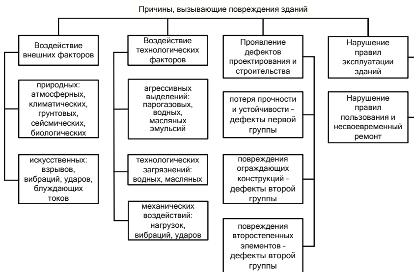
Рисунок 2.1 – Классификация причин повреждений зданий в процессе эксплуатации
