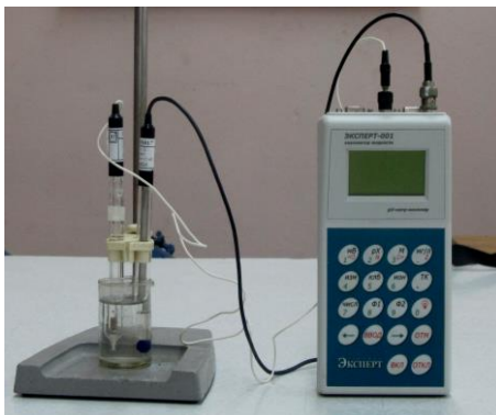
Рисунок А.2 – Исследование образца цементно-песчаной фракции анализатором жидкости «ЭКСПЕРТ–001-1»
