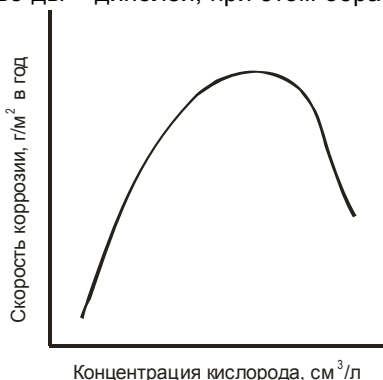
Рисунок 3.9 – Зависимость скорости коррозии от концентрации кислорода
