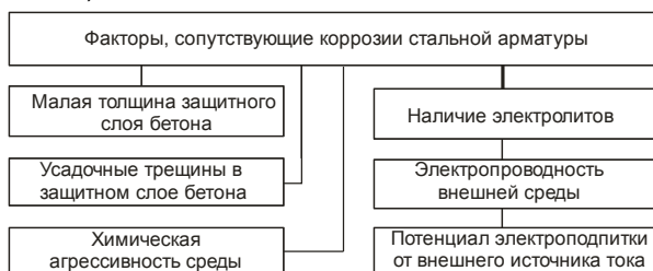
Рисунок 3.12 – Классификация факторов, сопутствующих коррозии стальной арматуры
