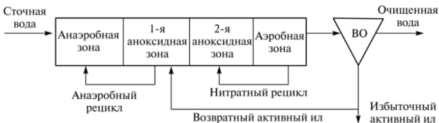
Рисунок 6.21 – Схема процесса MUST
