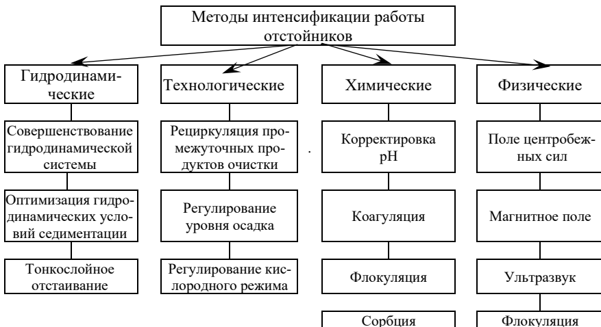
Рисунок 6.5 – Методы интенсификации работы отстойников
