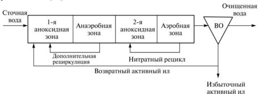
Рисунок 6.23 – Схема модифицированного процесса ЖНВ ( МЖНВ )
