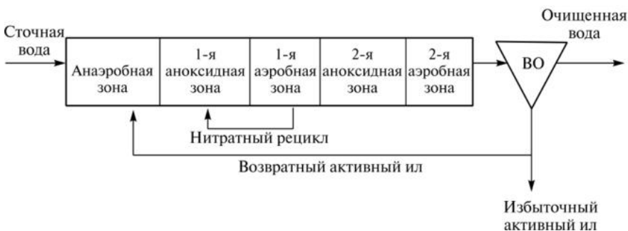
Рисунок 6.19 – Схема 5-стадийного процесса Барденфо
