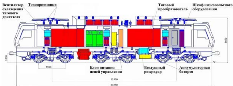
Рисунок 8.2 – Схематический вид электровоза
