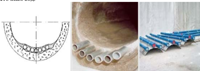
Рисунок 6.11 – Конструкции теплообменников, размещаемых в канализационных коллекторах
