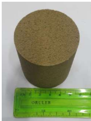
Рисунок 2 – Образцы для испытаний размерами 50×50 мм по ГОСТ 234097-78
