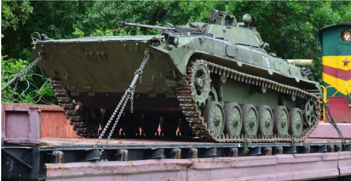
Рисунок 2 – Закрепление гусеничной техники при помощи УМК
