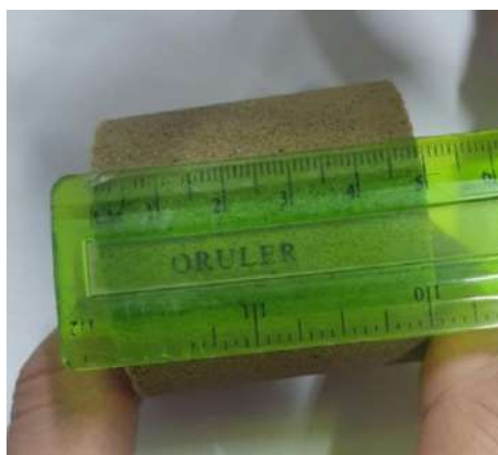
Рисунок 2 – Образцы для испытаний размерами 50×50 мм по ГОСТ 234097-78
