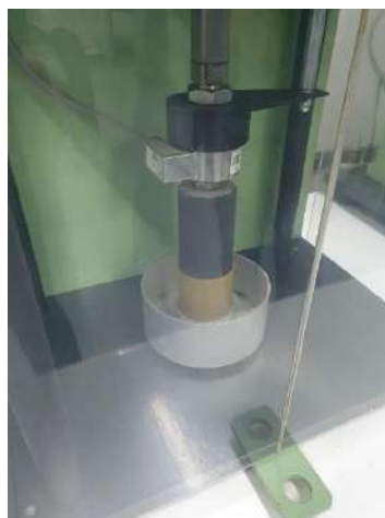
Рисунок 1 – Мини лабораторное оборудование PVF-C для адаптивности: а – общий вид; б – рукав со смесью
