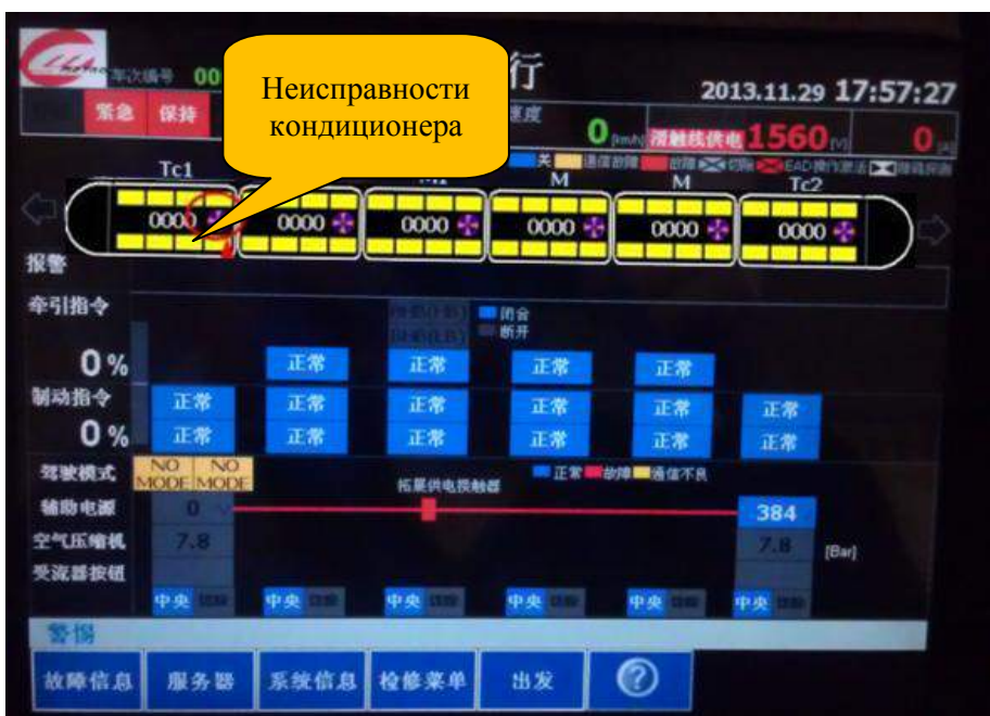
Рисунок 5 – Интерфейс движения экрана-DU после исправления
