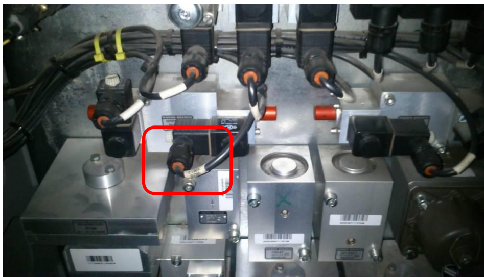
Рисунок 19.3 – Расположение электрического разъема клапана B61 на шкафу тормозной аппаратуры
