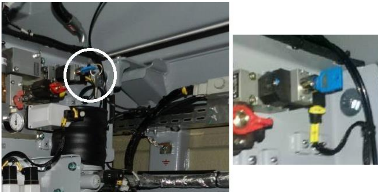
Рисунок 5.11 – Место расположения синего ключа (U99) шкафа тормозной аппаратуры
