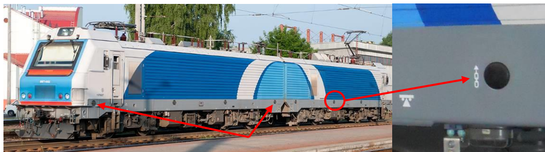
Рисунок 21.2 – Места для установки подъемных кронштейнов
