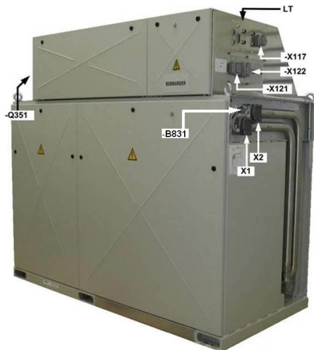
Рисунок 6.12 – Общий вид блока тягового преобразователя, закрытый щитами (вид спереди):
