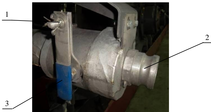
Рисунок 17.9 – Сливной патрубок бака отходов:
