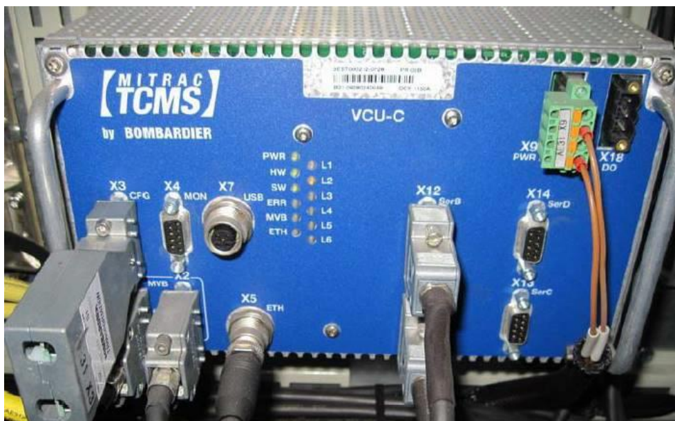
Рисунок 6.3 – Модуль VCU компьютеризированной системы управления TCMS
