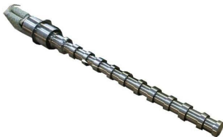
Рисунок 2 – Каскадный волновод-излучатель, присоединенный к магнитострикционному преобразователю без охлаждающего корпуса
