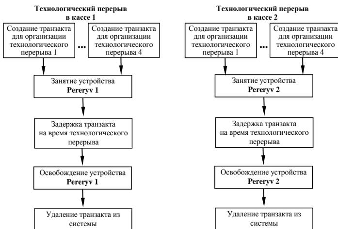
Рисунок 4.25 – Подсистема моделирования технологических перерывов в билетной кассе
