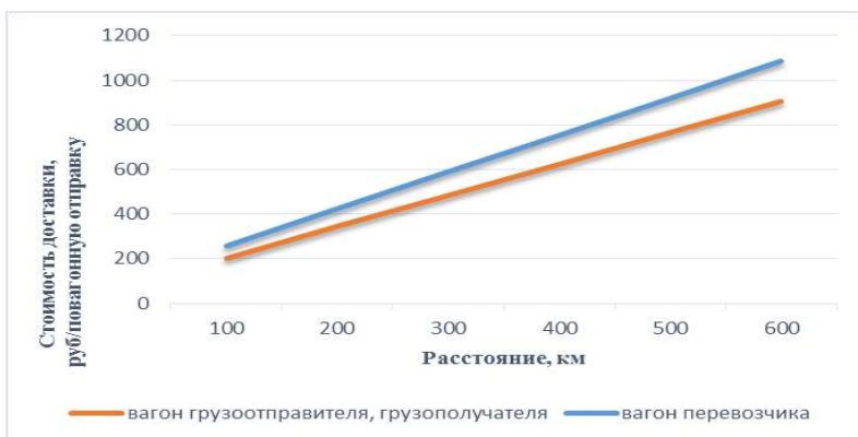
Рисунок 2 – Зависимость стоимости доставки груза железнодорожным транспортом в вагонах перевозчика и грузоотправителей, грузополучателей от расстояния перевозки при величине отправки 68 т
