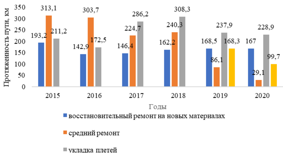
Рисунок 1 – Выполнение ремонтов в 2020 году
