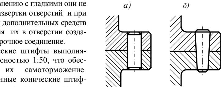
Рисунок 27 – Штифтовое соединение с цилиндрическими (а) и коническими (б) штифтами
