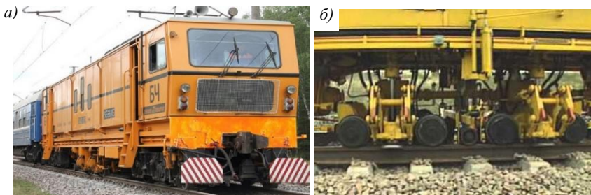
Рисунок 1.36 – Динамический стабилизатор пути DGS-62: а – общий вид; б – блок динамической стабилизации
