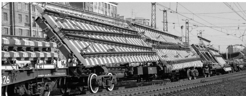
Рисунок 1.27 – Механизированные платформы для транспортировки блоков стрелочного перевода в габарите Т
