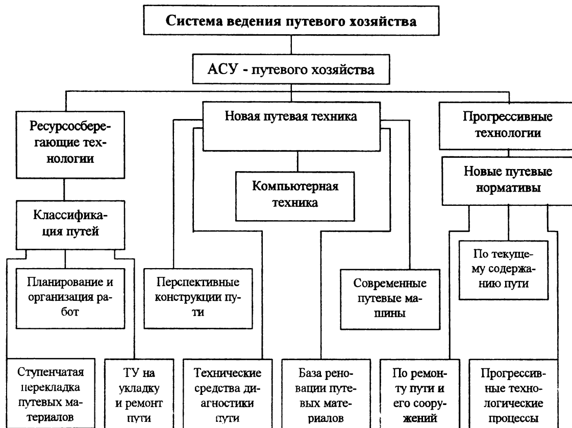
Рисунок 1 – Структурная схема базового обеспечения новой системы ведения путевого хозяйства
