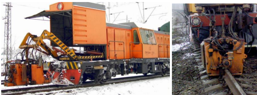
Рисунок 9.4 – Путьевая рельсосварочная самоходная машина ПРСМ-4
