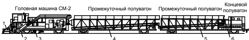
Рисунок 10.7 – Конструктивная схема снегоуборочный поезд ПТКБ-ЦП: 1 – крыло с ротационной щеткой; 2, 4, 5 – конвейеры; 3 – льдоскалывающее устройство; 6 – разгрузочное устройство
