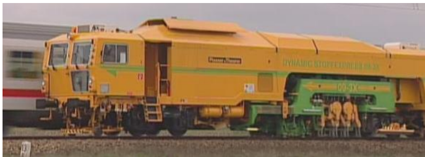
Рисунок 8.23 – Машина для комплексной выправки DYNAMIK EXPRESS 09-3X
