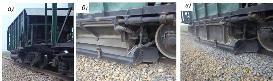
Рисунок 5.1 – Хоппер-дозатор ЦНИИ-ДВЗ: а – общий вид; б – перед началом выгрузки; в – во время выгрузки
