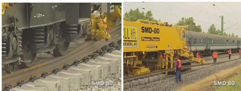
Рисунок 4.9 – Устройство железнодорожной и нерельсовой тележек комплекса SMD 80
