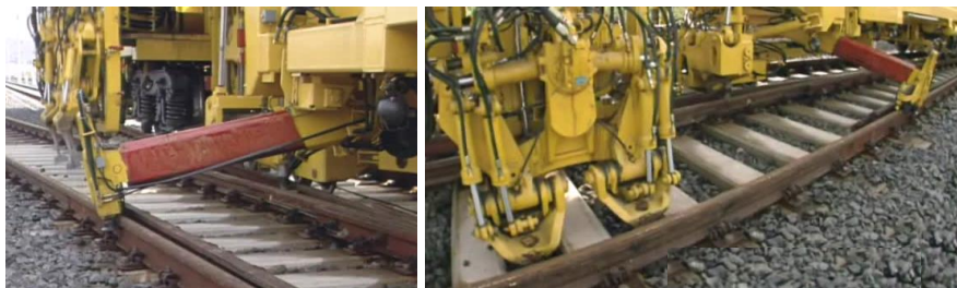
Рисунок 8.20 – Синхронное дополнительное подъемное устройство машин Unimat 08-275-4S, ВПРС-03, Unimat 08-475-4S
