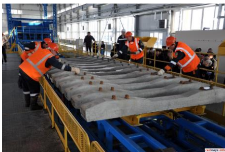
Рисунок 2.12 – Участок комплектации шпал элементами крепления
