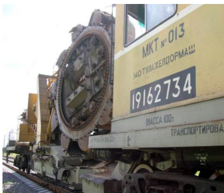
Рисунок 3.2 – Роторное устройство для вырезки грунта в транспортном положении
