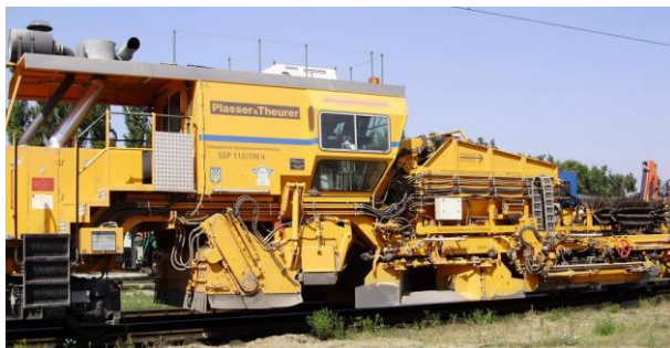
Рисунок 6.11 – Планировщик балласта SSP-110
