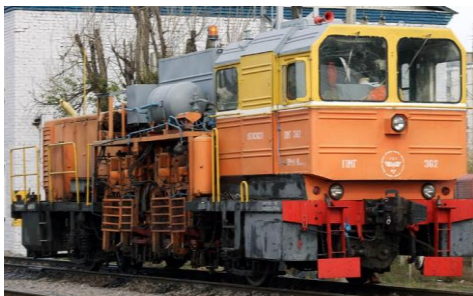
Рисунок 9.1 – Путевой моторный гайковерт ПМГ
