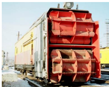
Рисунок 10.4 – Электрический снегоочиститель ЭСО-3
