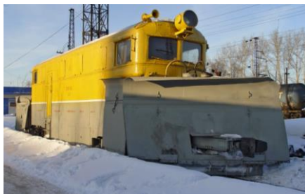
Рисунок 10.2 – Уборка снега снегоочистителем СДП-М на одну из сторон от пути
