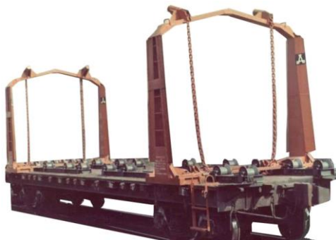
Рисунок 4.20 – Платформа, оснащенная унифицированным съемным оборудованием
