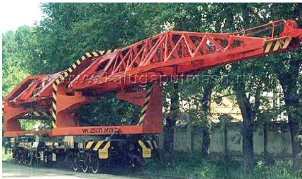
Рисунок 4.11 – Укладочный кран УК-25СП
