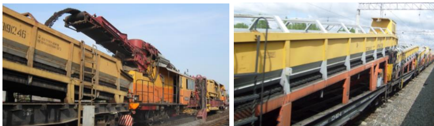
Рисунок 7.22 – Состав для перевозки засорителей и сыпучих грузов: а – заполнение состава для перевозки засорителей в процессе работы щебнеочистительной машины RM-80 UHR; б – вагоны состава для перевозки засорителей
