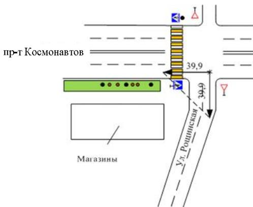
Рисунок 1.6 – Определение равностороннего треугольника боковой видимости в конфликте Т–Т
