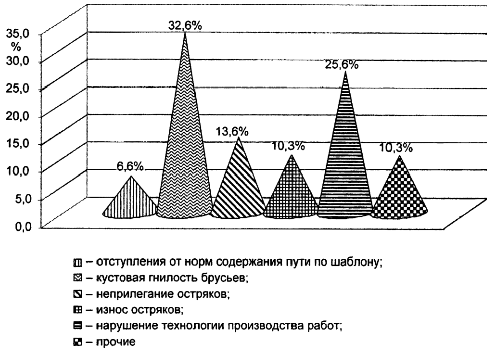
Рисунок 2 – Доля износов в нарушении безопасности движения на стрелочных переводах
