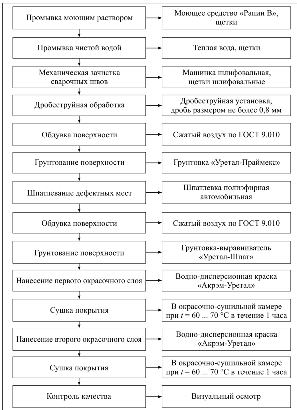
Рисунок 3 – Технологическая схема окраски кузова дизель-поезда водно-дисперсионной краской «Акрэм-Уретал» в локомотивном депо Лида
