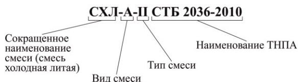
Рисунок 2.2 – Пример условного обозначения холодной литой асфальтобетонной смеси
