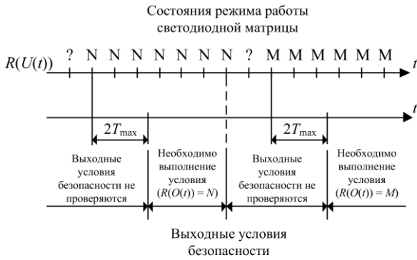
Рисунок 1 – Условия безопасности выходных ключей ССС-200-60
