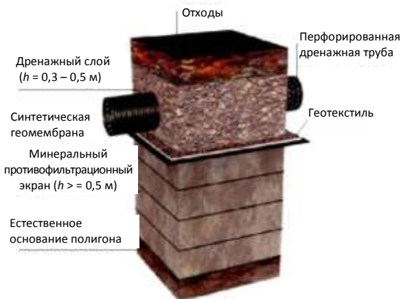
Рисунок 4.12 – Композитный двухслойный экран основания полигона
