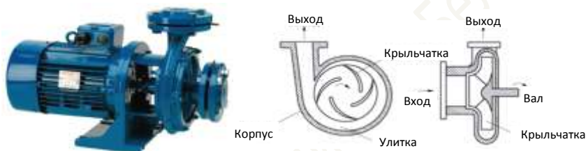
Рисунок 2.14 – Общий вид и конструкция центробежного насоса ( http://sovetystroy.ru/tumbs_3/nasosy-dlja-vody.jpg )
