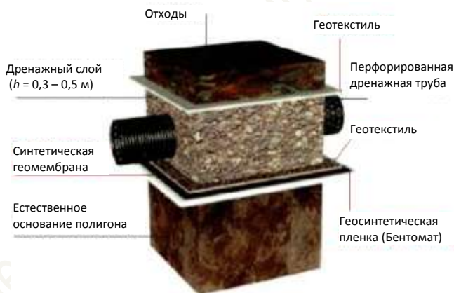
Рисунок 4.13 – Композитный синтетический экран основания полигона
