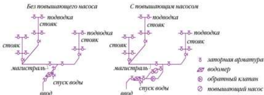
Рисунок 2.42 – Пример схем внутреннего водопровода
