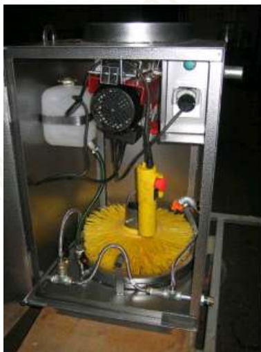
Рисунок 4.6 – Очистное устройство мусоропровода
