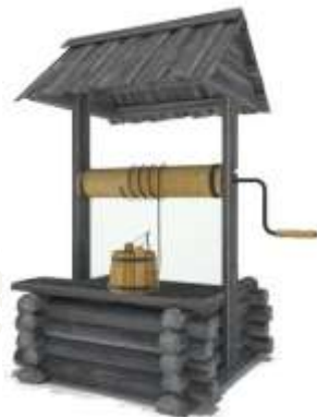
Рисунок 2.7 – Общий вид шахтного колодца
