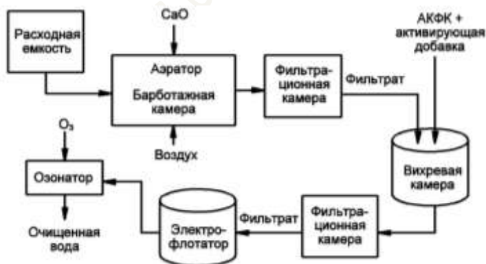
Рисунок 4.10 – Технологическая схема комплексной очистки фильтрата полигонов ТБО
