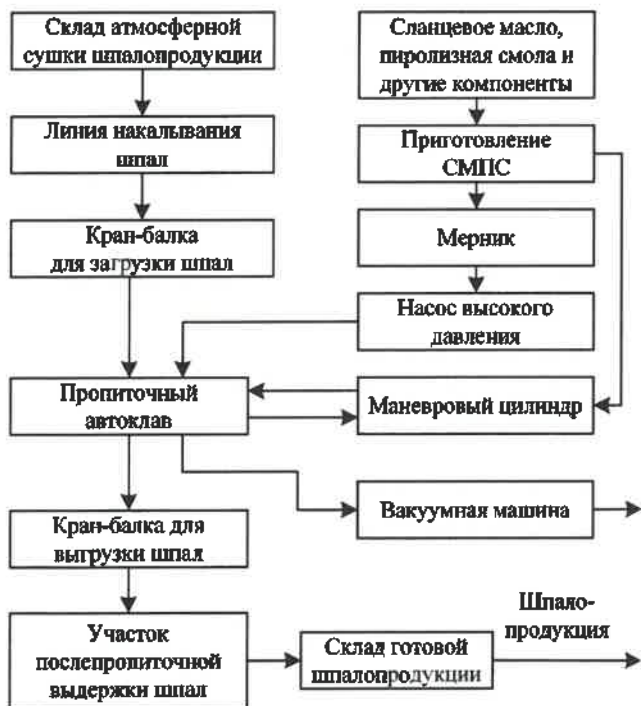
Рисунок 4 – Технологическая схема пропитки деревянных шпал эмульсионным защитным средством СМПС
