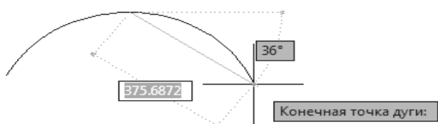
Рисунок 2.29 – Построение дуги по трём точкам
