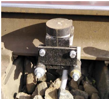
Рисунок 3 – Камера и датчик колесных пар напольного комплекса «СТЗ.ИНВ»
