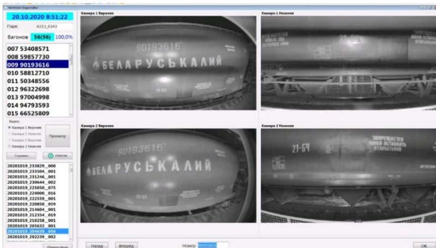
Рисунок 4 – Пример видеоизображения, поступающего в комплекс «СТЗ.ИНВ»
