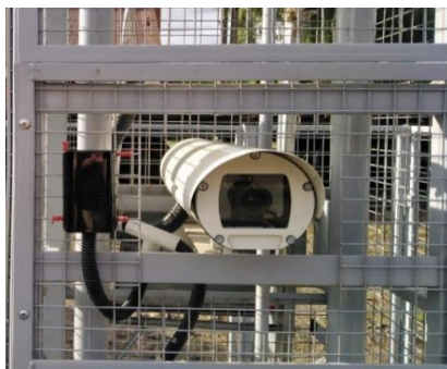
Рисунок 3 – Камера и датчик колесных пар напольного комплекса «СТЗ.ИНВ»
