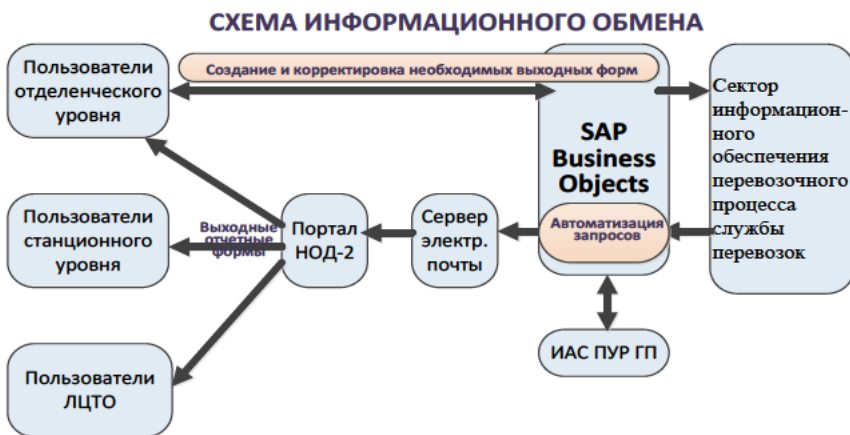
Рисунок 1 – Структурная схема формирования выходных форм для пользователей на основе использования SAP BusinessObject
