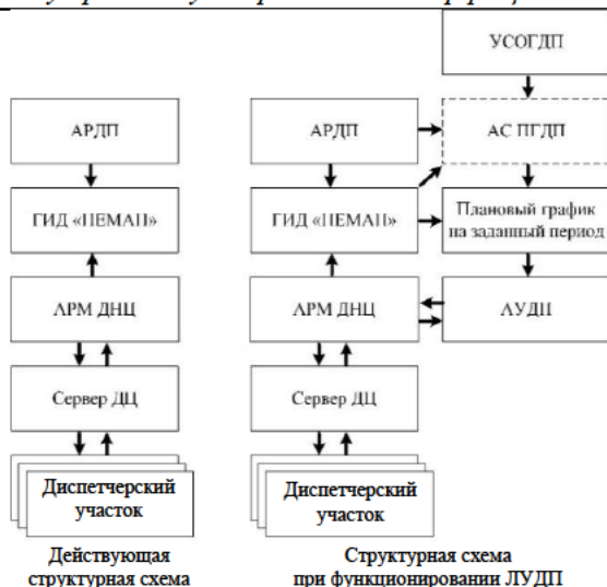
Рисунок 2 – Взаимодействие подсистем для обеспечения функционирования АУДП
