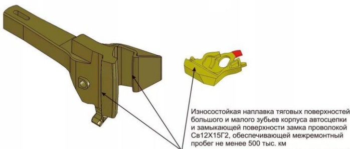
Рисунок 8.20 – Наплавляемые поверхности зубьев корпуса и замка автосцепки СА-3У
