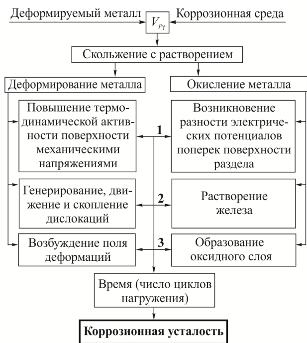
Рисунок 3 – Циклическое деформирование металла в пределах опасного объема
