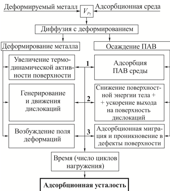
Рисунок 7 – Основные механизмы обратного эффекта, связанные с адсорбционной усталостью
