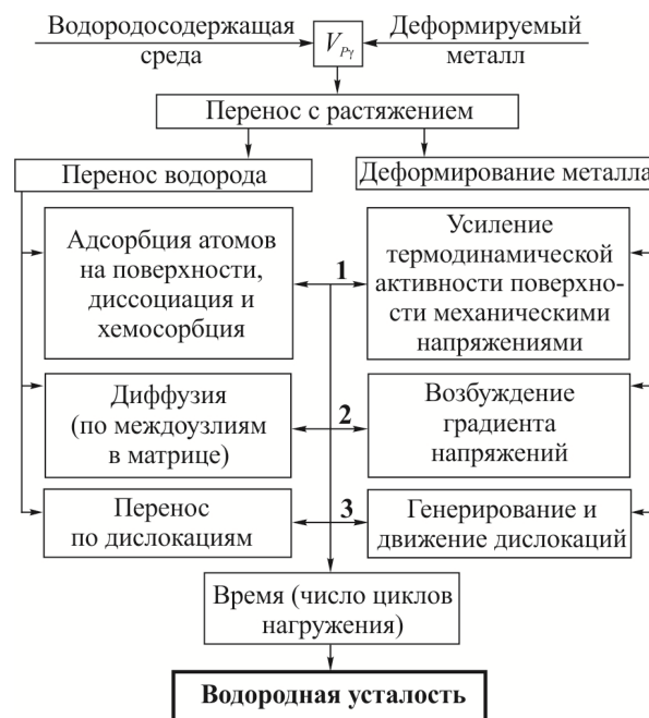
Рисунок 5 – Основные механизмы обратного эффекта, связанные с водородной усталостью
