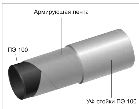
Рис. 1.67. Строение трубы Soluforce RTP
