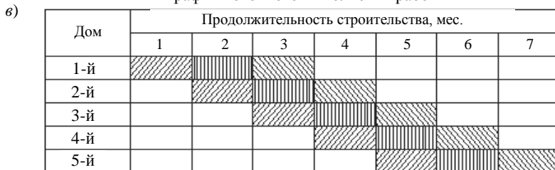
График поточного выполнения работ
