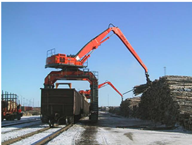
Рисунок 1.8 – Погрузка (выгрузка) круглого короткомерного леса кранами манипуляторами
