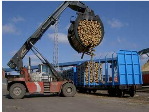
Рисунок 1.9 – Погрузка (выгрузка) круглого короткомерного леса погрузчиками
