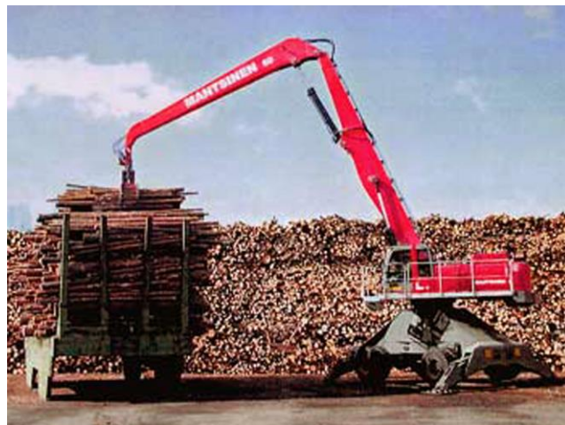
Рисунок 1.8 – Погрузка (выгрузка) круглого короткомерного леса кранами манипуляторами
