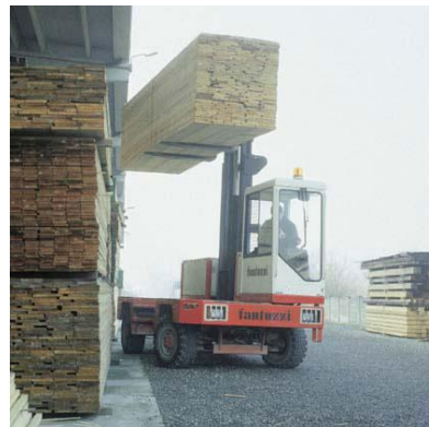
Рисунок 1.10 – Выполнение складских операций с пакетами леса погрузчиками с боковым расположением грузозахватных устройств
