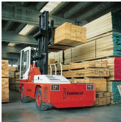
Рисунок 1.10 – Выполнение складских операций с пакетами леса погрузчиками с боковым расположением грузозахватных устройств
