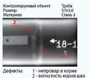
Рисунок 10.16 – Пример расшифровки результатов радиографического контроля с использованием канавчатого эталона
