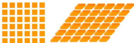
Рисунок 5.35 – Двумерная матрица ФАР-преобразователя
