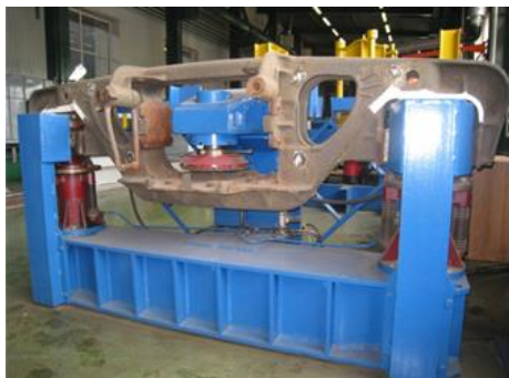
Рисунок 5.67 – Участок для АЭ-контроля боковых рам и наддрессорных балок в вагонном депо
