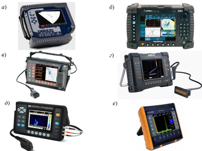
Рисунок 5.63 – УЗ-дефектоскопы, работающие на ФАР:
