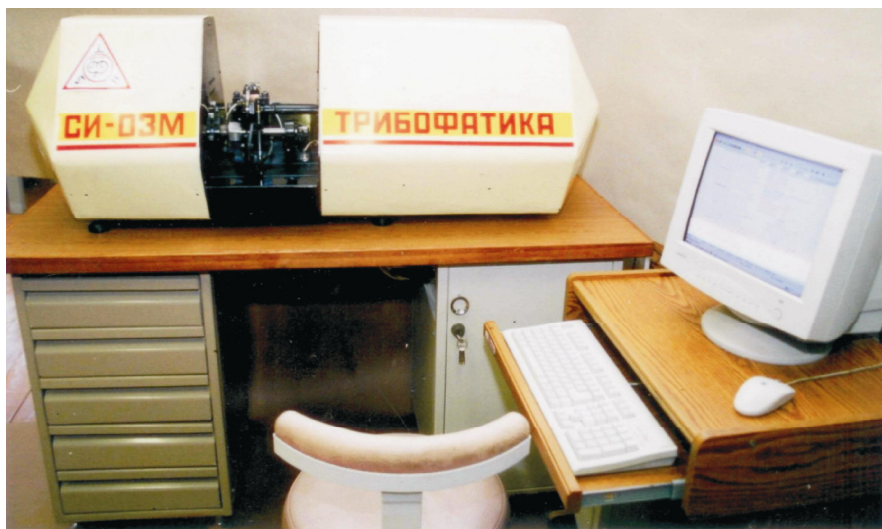
Рисунок 3 – Общий вид универсальной испытательной машины СИ-03М для износоусталостных испытаний
