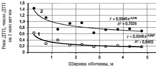
Рисунок 4.20 – Зависимость риска ДТП от ширины и наличия укрепления обочин на трехполосных дорогах [64, 71]:
