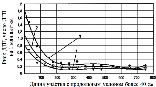
Рисунок 4.26 – Зависимость показателя риска ДТП от протяженности участков дорог различного типа с величиной продольного уклона более 40 % [64]:
