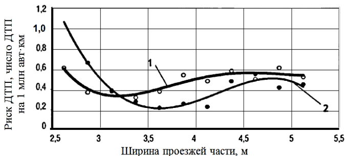
Рисунок 4.18 – Зависимость риска ДТП от ширины полосы движения на многополосных автомобильных дорогах [64]: 1 – без разделительной полосы; 2 – с разделительной полосой
