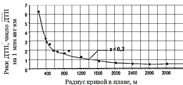
Рисунок 4.36 – Зависимость показателя риска ДТП от величины радиуса кривых в плане на двухполосной дороге при уровне загрузки движением 0,2 [64]
