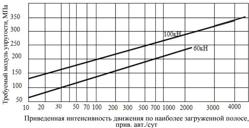
Рисунок 1.127 – Номограмма для определения требуемого эквивалентного модуля упругости при расчетах по упругим деформациям [56]
